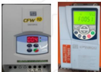
Fig. 01: Inversor CFW10 apresentando erro E04 e inversor CFW500 apresentando erro F0051.
