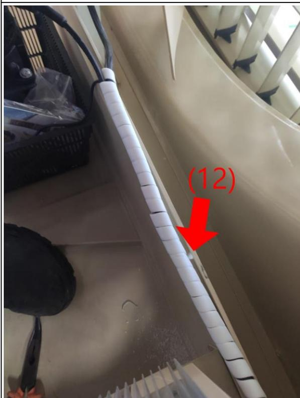
(12) Na parte interna do climatizador, fixado na borda do reservatório, se encontra um feixe de cabos envolto por uma espiral branca. Esses cabos deverão ser soltos do reservatório, a espiral branca desenrolada, para permitir a retirada do cabo do sensor de nível, conforme descrito abaixo no passo 13.
