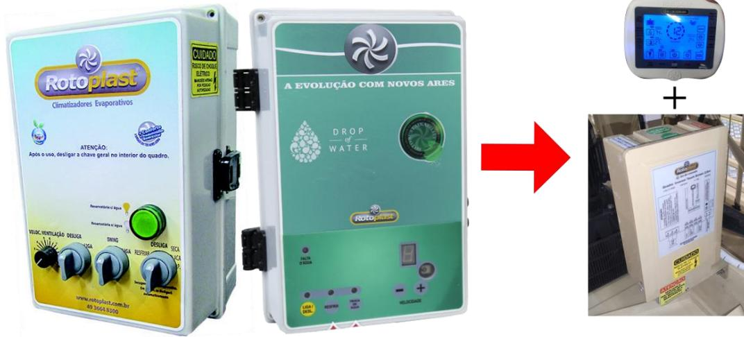
Abaixo, ilustração das alterações na parte externa do climatizador, quando realiza-se a substituição de quadro de comando modelo Confort ou Plus por painel Touch Screen:
