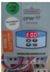
Fig. 01: Inversor CFW10 apresentando erro E00.
