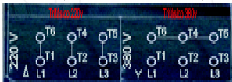
Figura 05: Esquema de ligação de motores trifásicos 220/380v.
