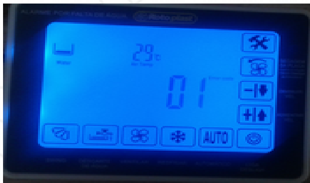
Fig. 01: Painel touch-screen apresentando o erro 01.
